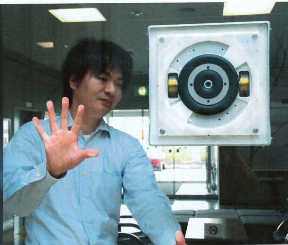
三宅徹社長(写真)が開発した「Wall Walker」。円形の吸盤で窓ガラスに吸着し、2つのタイヤで移動する。どんな角度に傾いた壁面でも自由に移動でき、人の手が届かない場所も清掃が可能。四辺にクリーナーブラシを装着して清掃を行う
